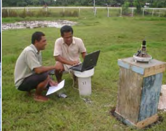
Des agents du service météorologique de Tuvalu installent et programment un pluviomètre du SMOC-IP à Funafuti.
