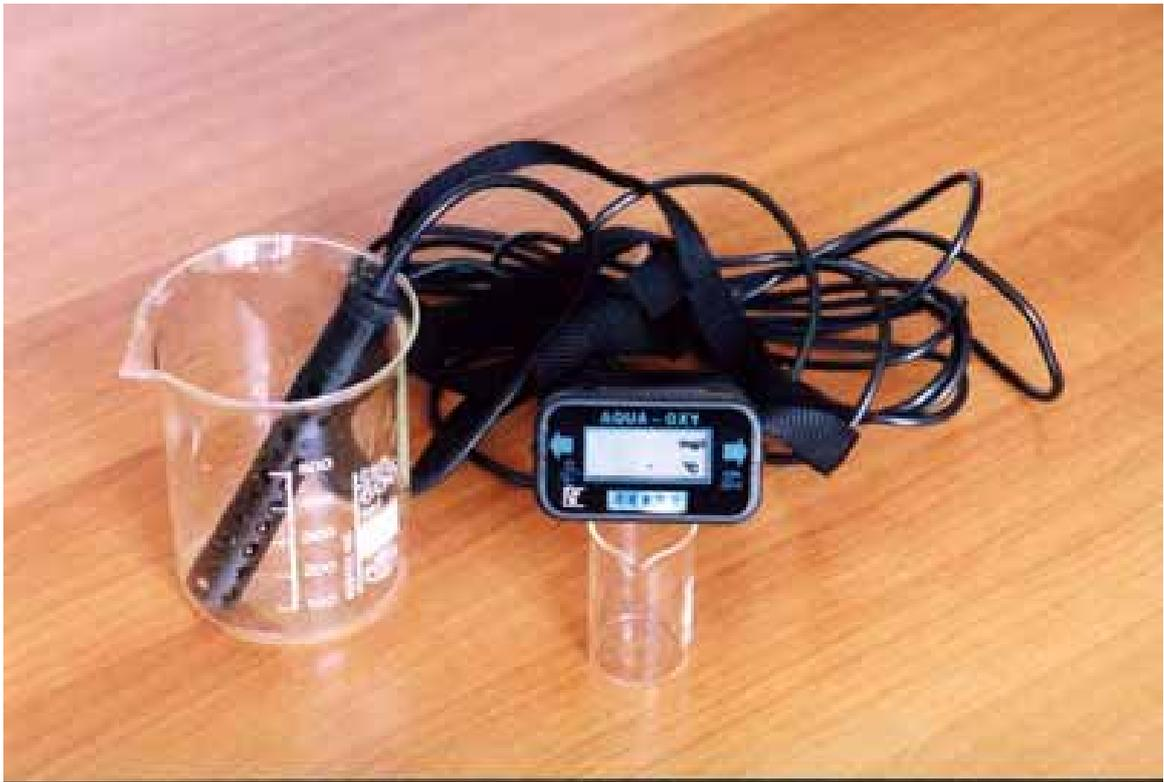
Фото 13. Термооксиметр AQUA-OXY для измерения концентрации растворенного кислорода и температуры.
