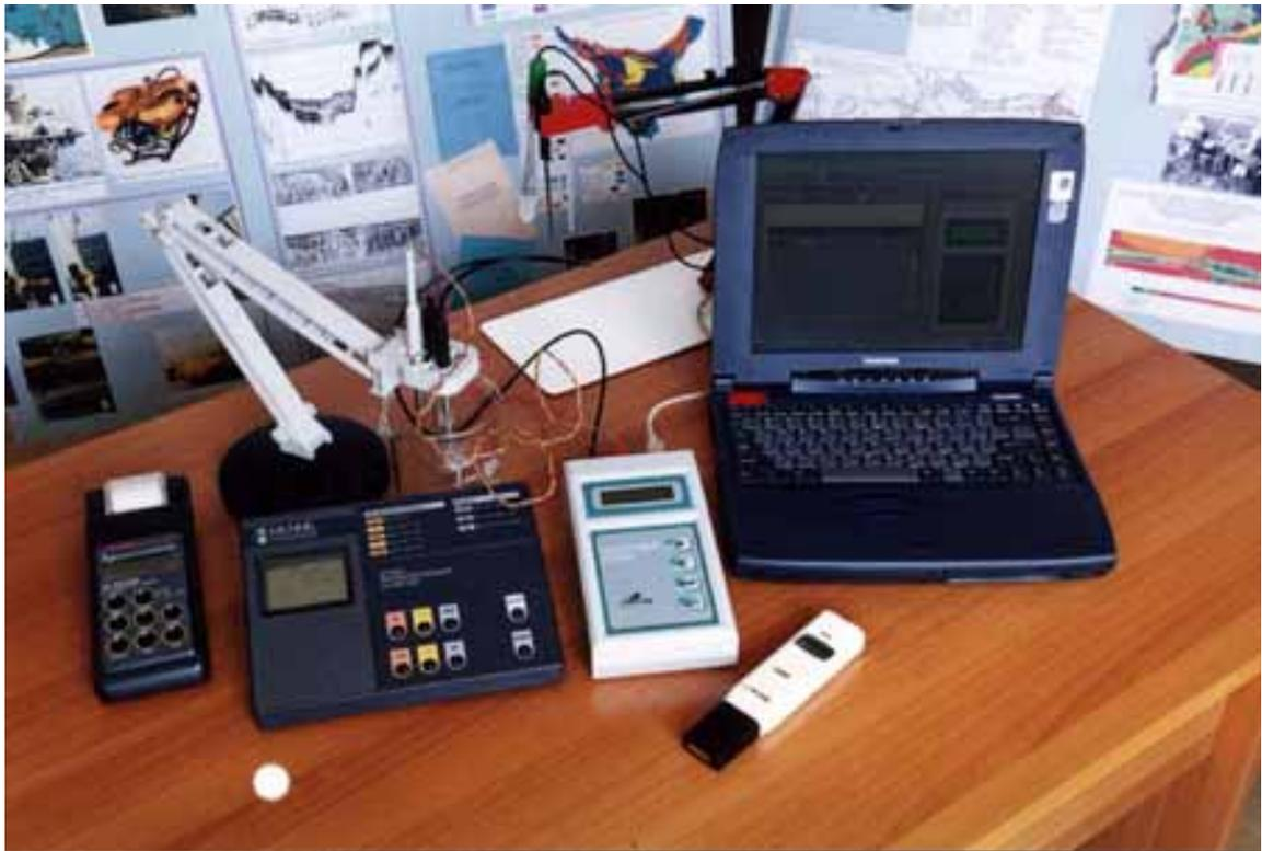
Фото 12. Оборудование для определения физико-химических показателей придонной воды.
