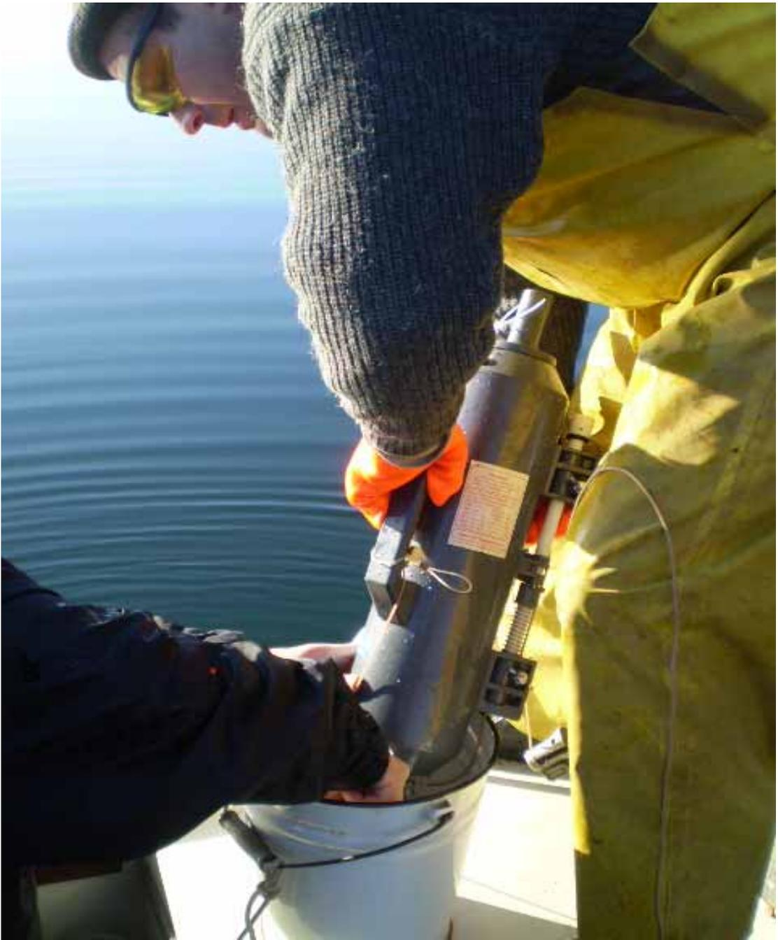
Фото 8. Отбор проб батометром на гидрохимию и загрязнение.
