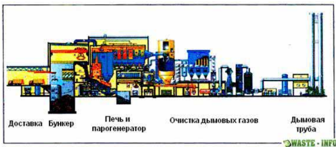
Рис. 4.2. Типичная установка для сжигания твердых бытовых отходов [Руководящие принципы, 2006]
