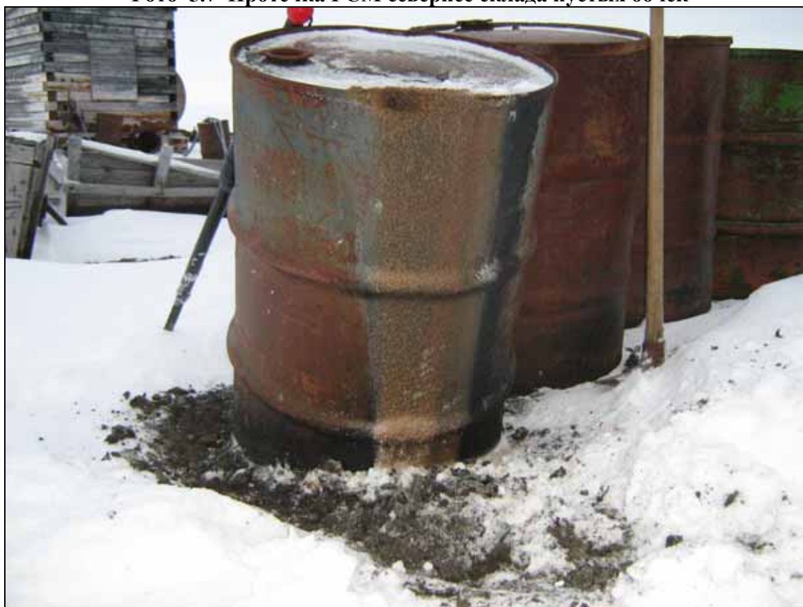
Фото 5.8 Протечка ГСМ возле здания дизельной станции
