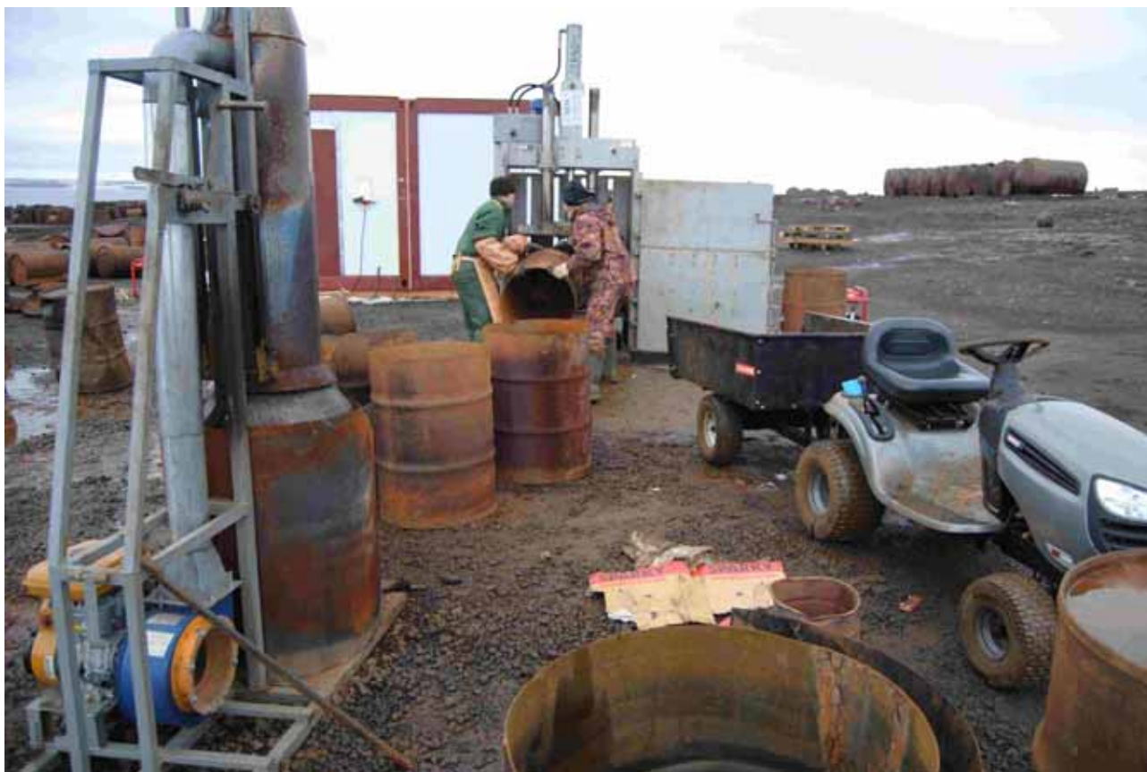
Рис.14.10. Рабочий момент компактирования бочки
