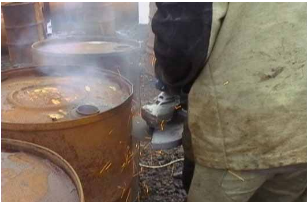
Рис. 14.7. Вскрытие бочек с помощью угловой шлифмашины
