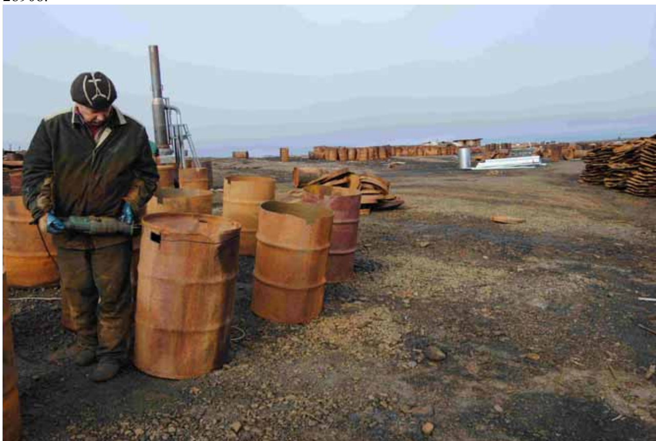
Рис.14.6. Вскрытие бочек с помощью сабельной пилы
