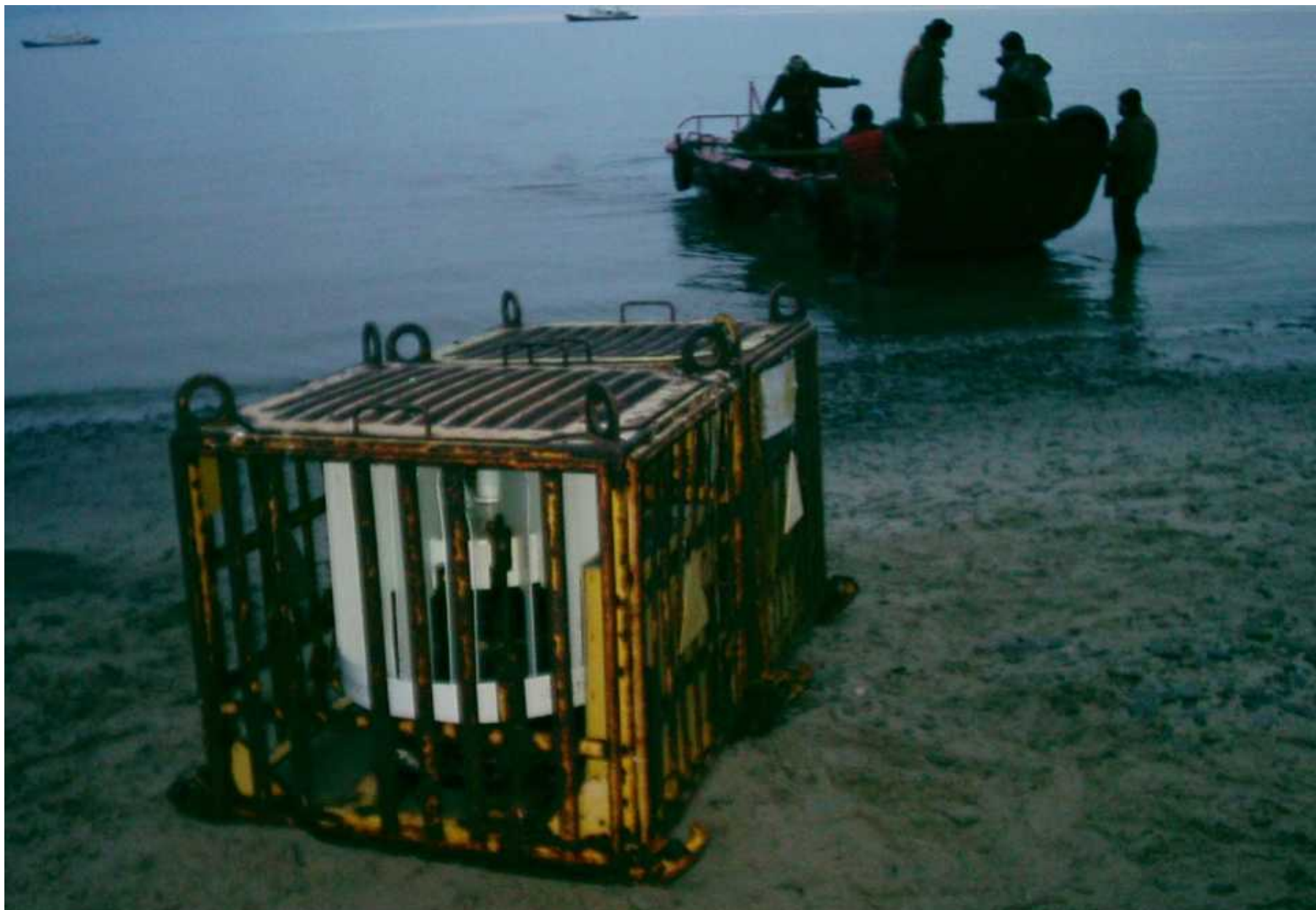
РИТЭГи Бета-М №97 с СНО "Преображения" (ближний на фото) и №35 с СНО "Опасный" на м. Косистый п-ова Хара-Тумус перед погрузкой на баржу (23.08.05г.).
