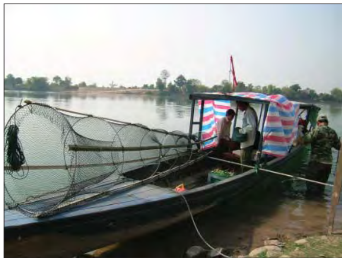
ຮູບ 11. ທິດລອງນຳໃຊ້ເຄື່ອງມືຫາປາ fyke net ທີ່ນຳມາຈາກປະເທດແດນມາກ.
