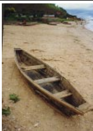
Figure 10 Un petit bateau en planches sans cadre. N. Tanzanie.
