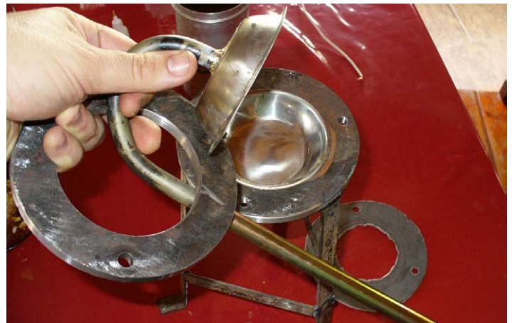
Atas: tutup retort dengan rapat, dan siap untuk digunakan Bawah: komponen retort sederhana sehingga mudah dibuka
