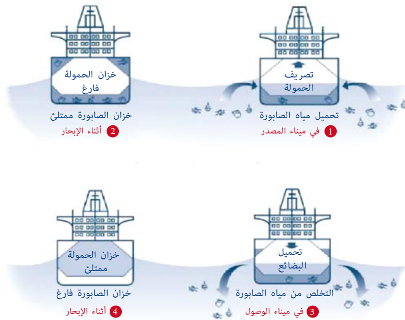
رسم توضيحي 1 مقطع عرضي للسفن يوضح خزان الصابورة ودورة مياه الصابورة (المصدر: البرنامج العالمي لإدارة مياه الصابورة 2002).
